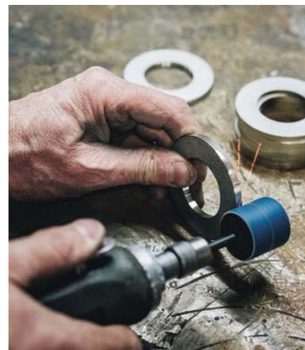
Was nicht passt, wird passend gemacht: In diesem Fall müssen Führungsräder nachgearbeitet werden
